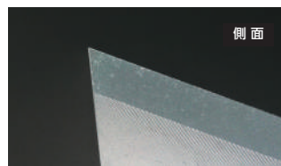
ランドがなく刃先先端からすくい面を形成 食付きが向上し、高精度・安定加工が可能(〜φ12)
