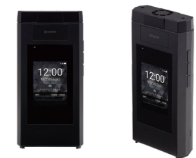
5Gコネクティングデバイス さまざまなエッジデバイスからのデータをクラウドにアップロードしたり、高解像度カメラやバイタルセンサなどに接続し、リアルタイムのAI解析を実現するなど、さまざまな機器を5G通信でつなぐ「ハブ」デバイス
