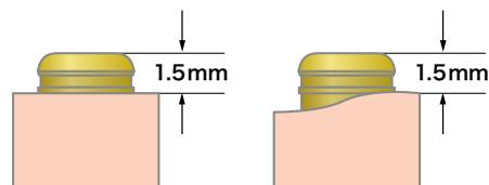
**ステップ2 LOCATOR アバットメントの装着**
