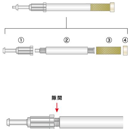
・LOCATOR リプレイスメントメールが装着された LOCATOR デンチャーキャップに LOCATOR メールリムーバブル部をまっすぐ差し込みます。尖った先端を、LOCATOR リプレイスメールに引っ掛け、LOCATOR デンチャーキャップから外します。
