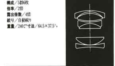
ムターT* I 2x ☆ メーカー希望小売価格 ¥55,000 (AE) ケース付 レンズとボディの間に装着して、使用レンズの焦点距離を2倍に変換するテレコンバータです。AE連動機構で、絞り優先AE、TLAストロボによるTTL自動測光にも連動。
