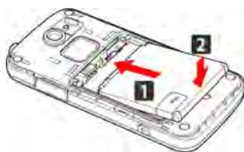
・バッテリーと本機の金属端子が合うように**1**の方向に差し込んでから、**2**の方向にはめ込みます。
