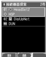
**5** WX310Kの周辺にあるBluetooth™対応機器を探索します。一覧が表示された後、接続したい機器を選び、**確定** を押します。
