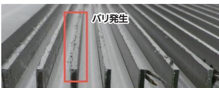
切削条件 :  $n = 3,200 \text{ min}^{-1}$ ,  $V_f = 150 \text{ mm/min}$ ,  $a_p = 6 \text{ mm}$
