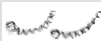
SM ブレード 切りくず切断メカニズム (外刃)
