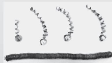
SMブレーカによる切りくず (SUS304)
