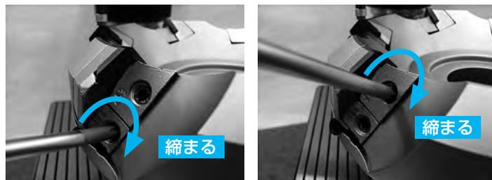
3) の刃振れ測定結果の数値より、最も刃先の高いコーナに合わせて調整する様に刃振れ調整ねじを締込む
