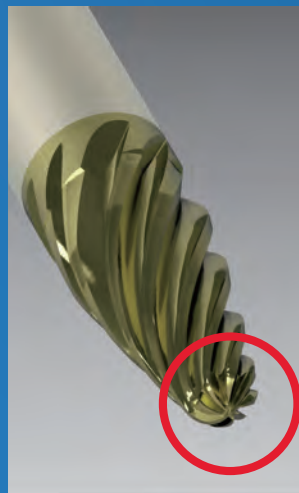
切りくずポケットの小さい先端刃はなるべく使用を避け、使用する場合は切込み、切削速度、送りともに下げてください
