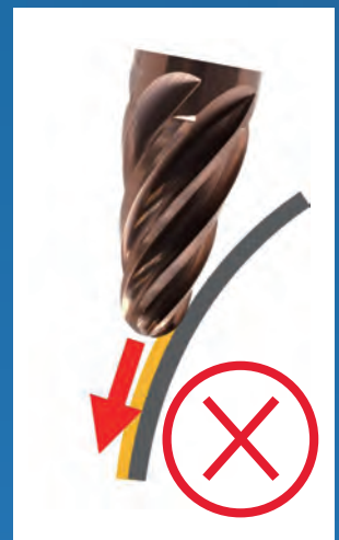
工具先端を押し下げる方向では無く、可能な限り引き上げる方向で加工を行ってください
