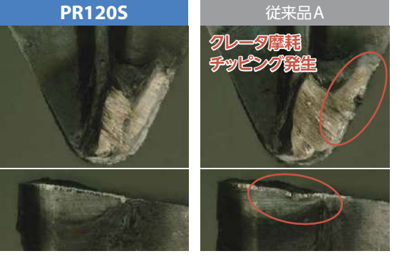
切削条件 : V_c = 150 \text{ m/min} , a_p = 1.0 \text{ mm} , f = 0.08 \text{ mm/rev} , Wet SUS316L DCGT11T304タイプ
