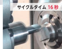
エンドミル加工 先端角90° エンドミル 他社品 n=1,800min -1 Vf=300mm/min 被削材：S45C ø20mm
