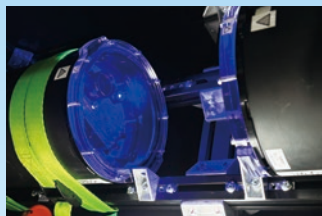
京セラが研究開発中の1Gbps 短距離水中光無線通信システム
