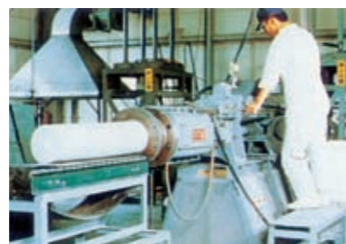
■押し出し成形 可塑性をもたせた原料を所定の口金から押し出して形づくりします。
