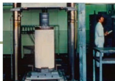
■ホットプレス 原料粉末を型に入れ、上下圧を加えながら昇温し、高密度の焼結体が得られます。
