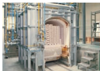
■焼成 材料に応じた雰囲気の中で、高温下で焼結させます。
