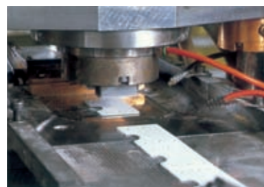
■加圧成形 金型に粉末を充填し、上下パンチで圧力を加えます。
