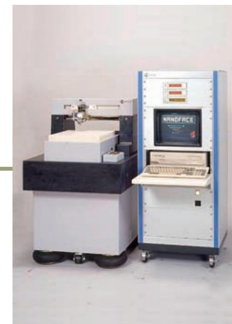
■検査 セラミックエアースライドを用いた高精度測定器等を用いて、高度な品質を保証。
