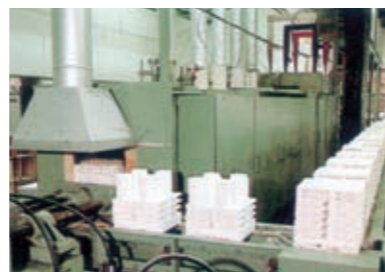
■焼成 材料に応じた雰囲気の中で、高温下で焼結させます。
