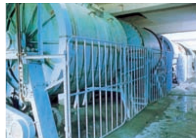
■原料調合・粉碎・混合 調合した原料をミルに入れ、粉碎と混合を行い粒子径の揃った泥漿を作成。
