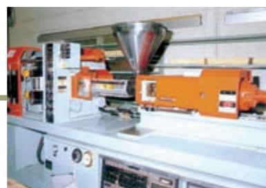
■射出成形 熱可塑性プラスチックを原料に加え加熱しながら金型の中に射出して成形。
