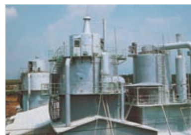
■噴霧・乾燥 ボールミルから送られてきた泥漿を噴霧し、熱風で瞬間的に乾燥させて顆粒の粉末に。
