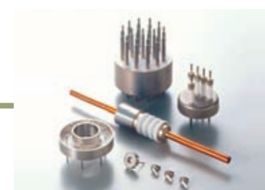
■メタライジング セラミックス表面に金属層を作り、メッキ加工、ロー付け加工を行い、金属との気密封着を可能にします。
