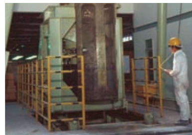
■ラバープレス ゴム型に粉末を充填し、高压筒の中で水圧を加えて素材を成形。
