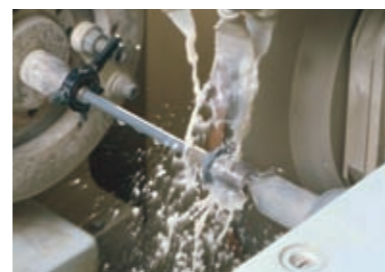
■研削・研磨 ダイヤモンド砥石を使った研削や研磨加工により、高精度な製品に。
