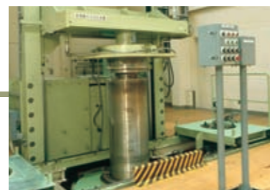
■HIP（熱間静水圧プレス） 成形物にガス圧を加えながら温度を上げて焼結。均一圧がかかるため高密度の焼結体が成形されます。
