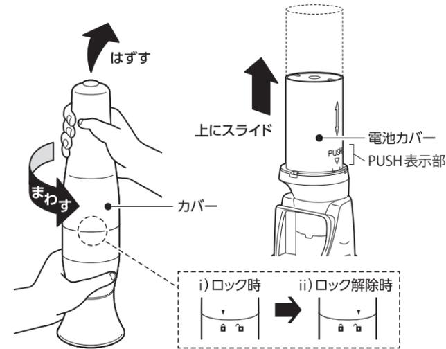
2. モーターユニットの上部が電池ケースになっています。アルカリ単3形乾電池・ニッケル水素充電電池(別売)を電池ケース内の記載に従って正しい方向に入れてください。
