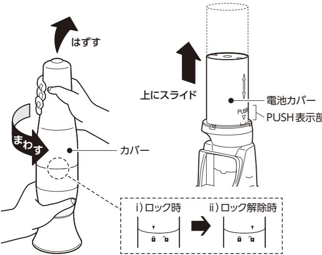
2. モーターユニットの上部が電池ケースになっています。アルカリ単3形乾電池・ニッケル水素充電池(別売)を電池ケース内の記載に従って正しい方向に入れてください。
