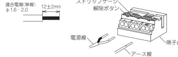
▲ 電源線は解除ボタンを押さずに引き抜かないでください。接点金具が変形し、焼損、漏電、感電、不点灯の原因となります。
