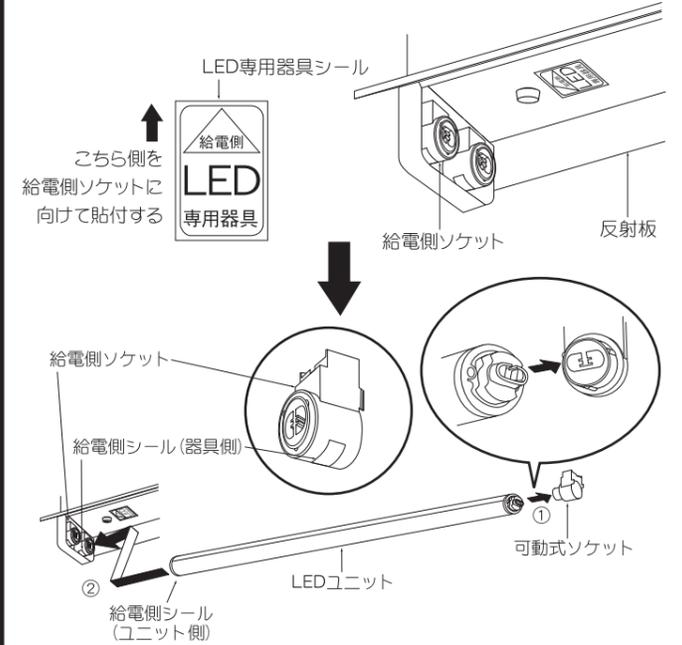
△ 接続不完全や取付け方向が反対の場合、火災・感電・器具故障の原因となります。
