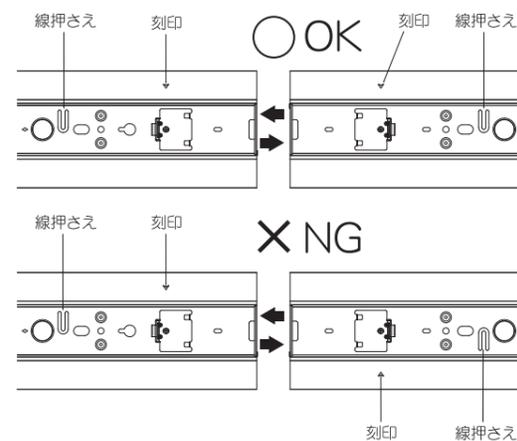
(2) 器具本体側面の連結部の凸と凹を、連結する器具本体側面の連結部の凹と凸に合わせて取付けてください。
