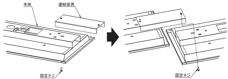
△ 取付部の強度が不十分な場合、埋込穴寸法が大きい場合は、器具落下・光モレの原因となります。
