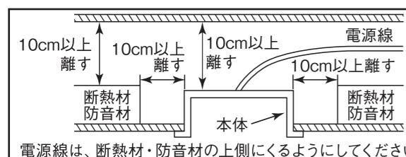
電源線は、断熱材・防音材の上側にくくるようにしてください。
