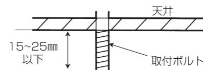
注) 取付ボルト長さは、天井面より 15~25mm 以下にする。
