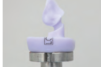
CAMで削られたe.max CAD。
