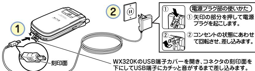
WX320KのUSB端子カバーを開き、コネクタの刻印面を下にしてUSB端子にカチッと音がするまで差し込みます。
