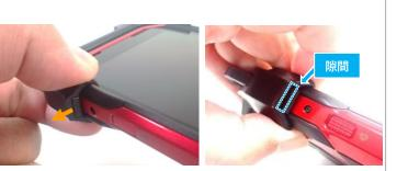
隙間が空いたら、先端がずれるまでスライドロックを矢印方向に引っ張ってください。 その後、反対側も同じようにスライドロックをずらしてください。
