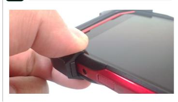
2 スライドロックとハードカバーに隙間ができるまで、 スライドロックを矢印方向に引っ張ってください。
