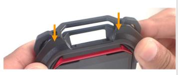
取付確認として、先端が同一面になるまでスライドロック 上側を押してください。その後、スライドロックとハード ホルダーの両端が同一面になっていることを両側確認して ください。
