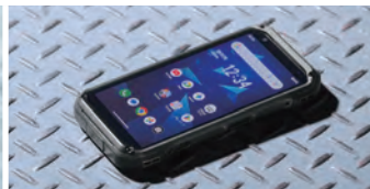
高温動作：60℃で連続3時間の動作試験を実施
