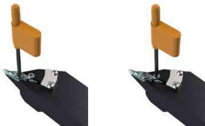
1. インサートを指先で拘束面に押し当てた状態で中心のメインスクリューを締める
