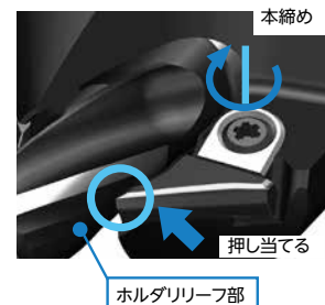
fig. 5 インサートの本締め
