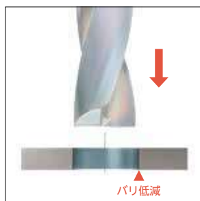
薄板の突き加工
