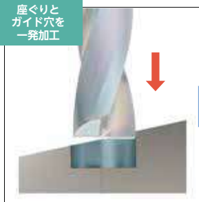
傾斜面への座ぐり・ガイド穴加工
