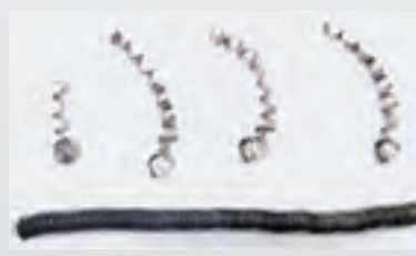
SMブレーカによる切りくず(SUS304) Chips by SM chipbreaker (SUS304)
