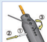
図1 位置決めピン装着方法 Fig. 1: How to use adjustment pin
