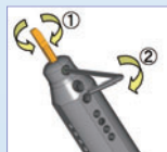
図2 チップ装着方法 Fig. 2: How to fix bar
