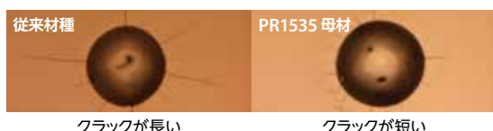
ダイヤモンド圧子によるクラック比較 (当社比較)
