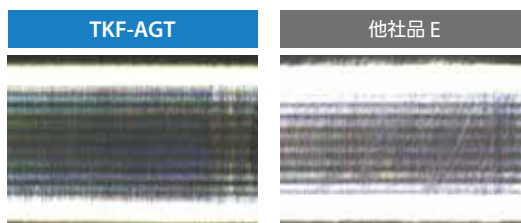
横送り加工の仕上げ面品位の比較 (当社比較)
