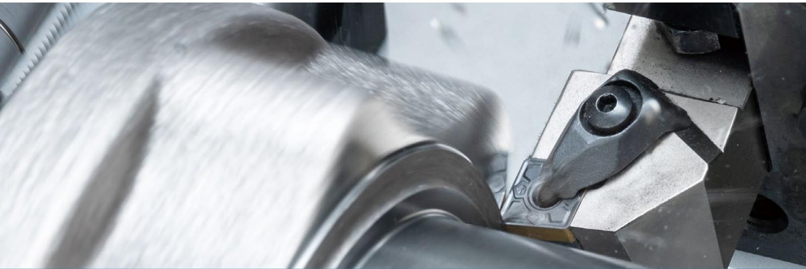
独自の強靱コーティングで鑄鉄の長寿命・安定加工を実現
