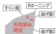
AMブレーカ刃先断面
