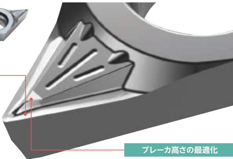
すくい面、底面、ブレーカ面の3面で切りくずを確実にコントロール
