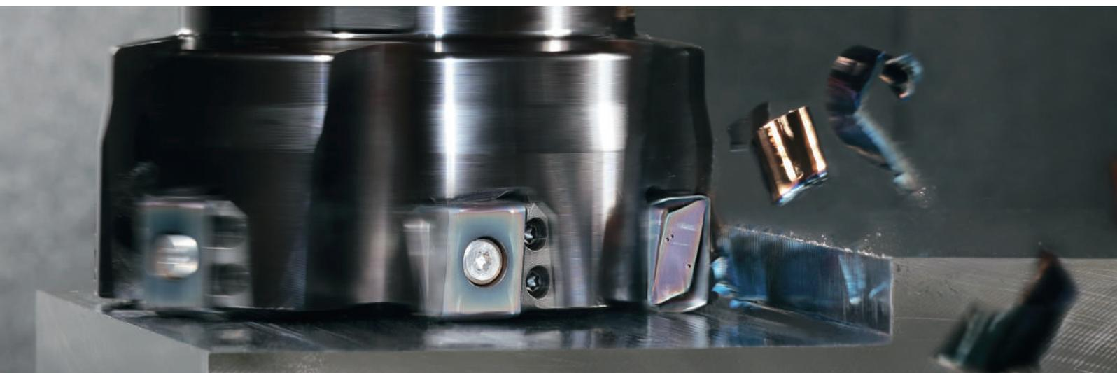
高切込み・高送りに対応。強靱チップと高剛性ホルダで重切削加工の加工能率向上
