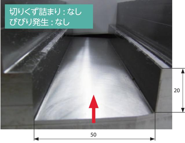
切削条件:  $V_c = 40 \text{ m/min}$ ,  $a_p \times a_e = 20 \times 50 \text{ mm}$  (溝加工),  $f_z = 0.08 \text{ mm/t}$ ,  $\phi 50$  (5刃列), Wet (外部+内部) 被削材: Ti-6Al-4V マシン: BT50
