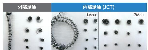
切削条件:  $n = 780 \text{ min}^{-1}$  (一定),  $V_c = 120 \text{ m/min}$ ,  $f = 0.08 \text{ mm/rev}$ , Wet 被削材: SCM415 ( $\phi 50$ ) 刃幅: 3 mm (PM プレーカ)
