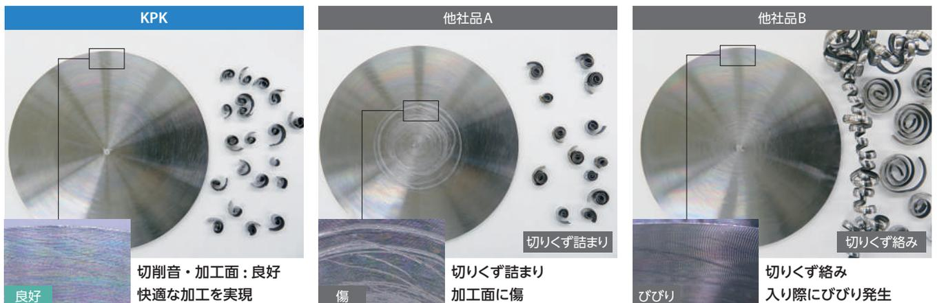
切削条件：n = 320 min<sup>-1</sup> (一定), Vc = ~100 m/min, f = 0.12 mm/rev, Wet (外部給油) 被削材：SCM435 (φ100) 刃幅：3mm
