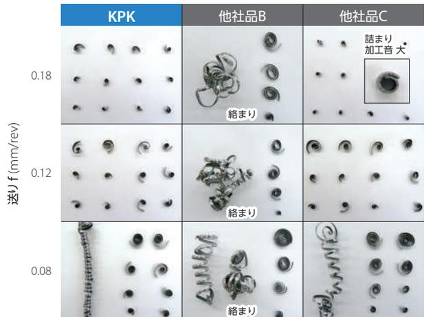
切削条件:  $n = 780 \text{ min}^{-1}$  (一定),  $V_c \sim 120 \text{ m/min}$ , Wet (外部給油)
