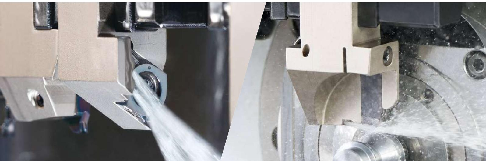
直接給油で配管レスに対応。優れた切りくず処理と長寿命加工を実現
