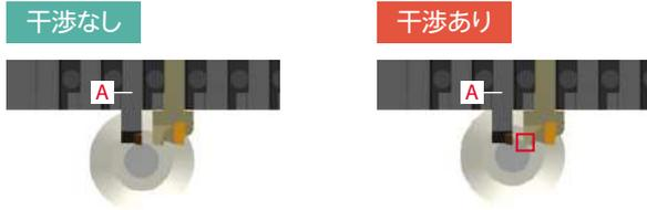
工具Aの最大切込みの目安 (mm)
