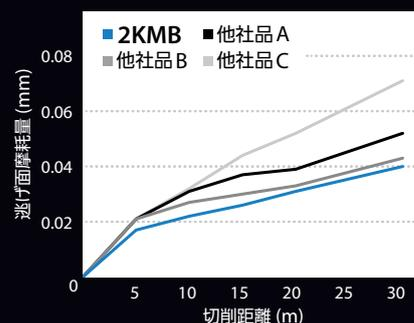
切削条件:  $n=13,700 \text{ min}^{-1}$ ,  $V_f=1,190 \text{ mm/min}$ ,  $ap \times ae=0.08 \times 0.2 \text{ mm}$ , Wet (ミスト)  $\phi 2$
