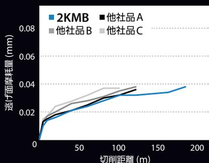
切削条件:  $n=20,000 \text{ min}^{-1}$ ,  $V_f=1,320 \text{ mm/min}$ ,  $ap \times ae=0.08 \times 0.2 \text{ mm}$ , Wet (ミスト)  $\phi 2$
