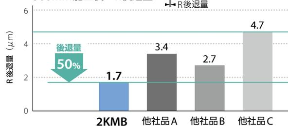
切削条件: n=40,000min<sup>-1</sup>, Vf=70mm/min, ap×ae=0.003×0.005mm, Wet (油性) 肩加工 SKD11 (60HRC) ø0.1 (ロングネック)
