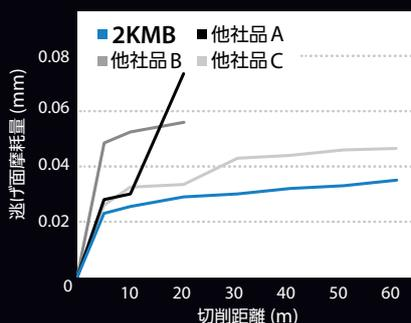
切削条件:  $n=16,900 \text{ min}^{-1}$ ,  $V_f=1,320 \text{ mm/min}$ ,  $ap \times ae=0.08 \times 0.2 \text{ mm}$ , Wet (ミスト)  $\phi 2$
