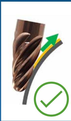
工具先端を押し下げる方向では無く、可能な限り引き上げる方向で加工を行ってください
