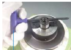
インサート締結用 レンチTTP-20 (20IP)
