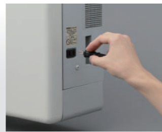
エコライン EX は本体側面に自立運転出力用コンセントを装備。写真は型式:PVN-553
