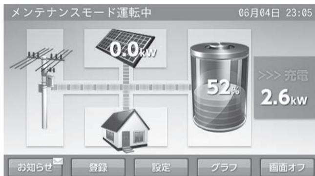
「運転モードを選ぶ ④充放電時刻を設定する」(P.20 ページ) で設定されている充電開始時刻に充電を行い、その後、設定している通常動作モードで、時間帯に関係なく、蓄電池から放電を行います。メンテナンスモード終了後は、通常モードに戻ります。
