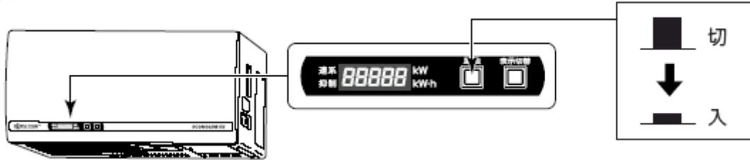
数分後、連系表示ランプが点灯して、発電を開始します。
