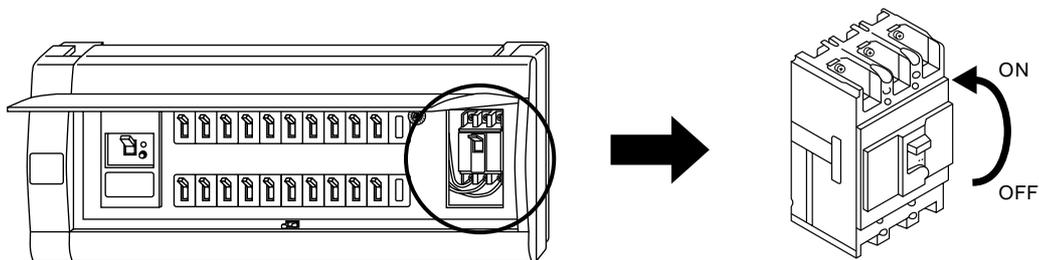
分電盤、サービスブレーカの形状が異なる場合があります。また、サービスブレーカは、分電盤の外に設置される場合もありますので、必ず設置場所を施工業者にご確認下さい。
