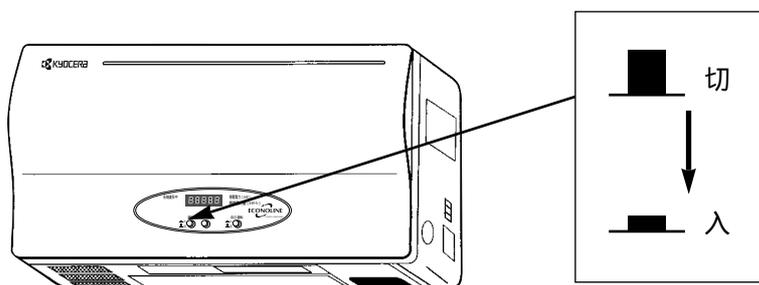
数分後、系統連系中ランプが点灯し、運転を開始します。
